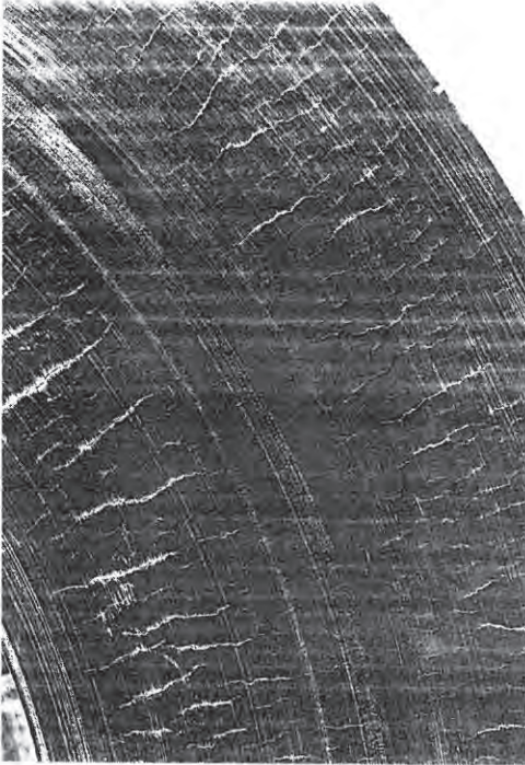
Bild 1.3.1: Wärmerisse in der Reibfläche einer Brems-scheibe aus Grauguß
