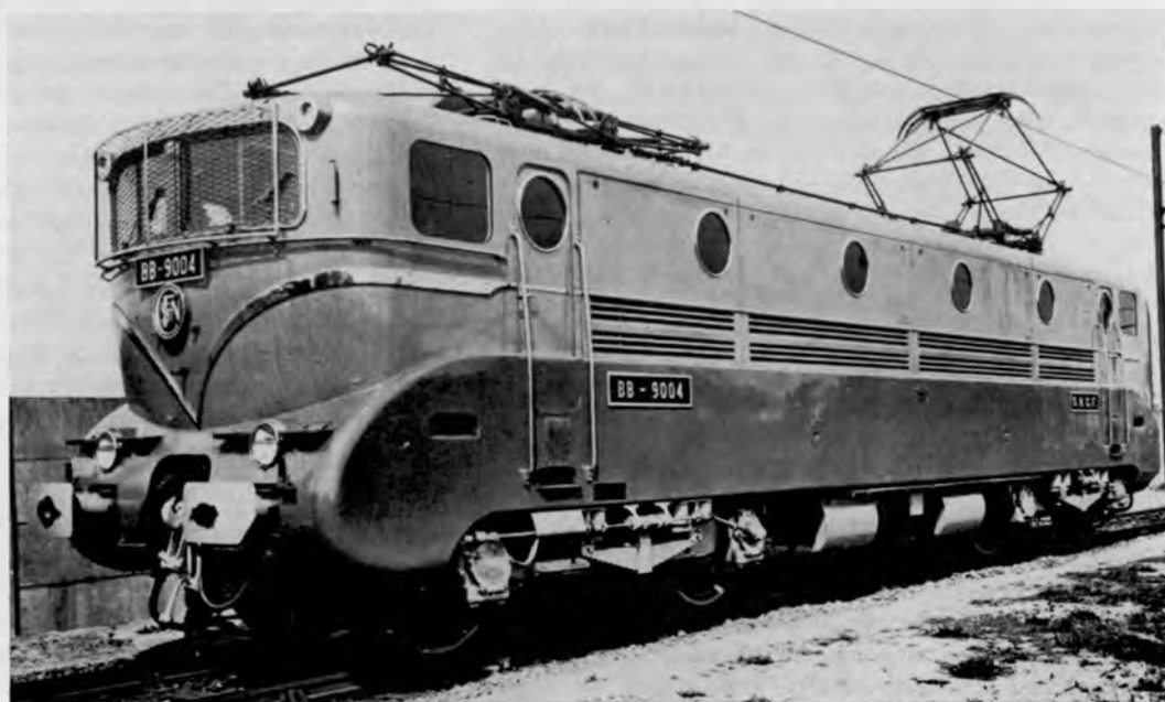
Bild 9. Elektrische Lokomotive BB 9004 ( B_0, B_0 ) der SNCF = 1500 V. G = 84\text{ t} , N = 2\,980\text{ kW} , V_{\max} = 160\text{ km/h} , D = 1250\text{ m/m} . Die Lokomotive erreichte am 29. 3. 1955 mit geänderter Zahnradübersetzung mit 3 Wagen, G = 103,5\text{ t} , auf der gleichen Versuchsstrecke 331 km/h. Max. aufgenommene Leistung am Stromabnehmer 9 400 kW.
