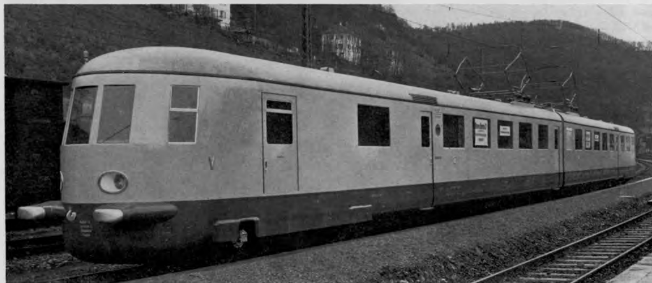
Bild 6. Elektrischer Schnelltriebwagen \sim 16\frac{2}{3} Hz, 15 KV, 2'B 0 ' + B 0 '2'. ET 11 der Deutschen Reichsbahn. N = 4 x 355 = 1 420 KW; V max = 160 km/h; Eigengewicht 103 t; spezifische Leistungszahl 13,8 kW/t; Baujahr 1934.
