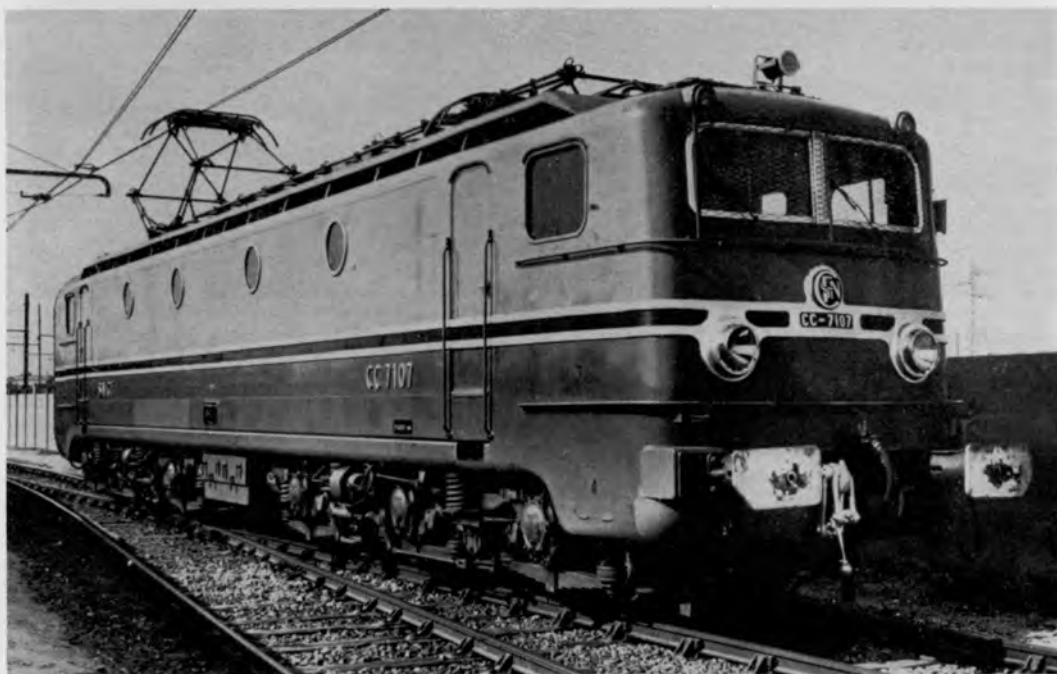
Bild 8. Elektrische Lokomotive CC 7107 ( C_0, C_0 ) der SNCF = 1500 V. G = 106\text{ t} ; D = 1250\text{ m/m} , N = 3\,480\text{ kW} , V_{\max} = 160\text{ km/h} . Die Lokomotive erreichte am 28. 3. 1955 mit geänderter Zahnradübersetzung mit 3 Wagen, G = 103,5\text{ t} auf der Versuchsstrecke Lamothe-Morcenx (Linie Bordeaux-Irun) zwischen km 76 und 68 die Rekordgeschwindigkeit von 331 km/h (record mondiale).
