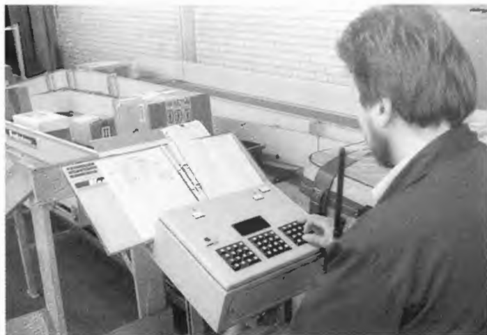
Bild 2: Die Leitdaten (Postleitzahlen) zur Steuerung des Guts werden über eine Tastatur eingegeben
