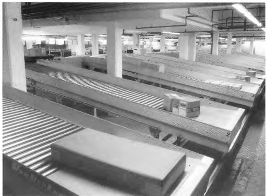
Bild 1: Bei den acht aufkommensstärksten GEP-Knoten wurden Hochleistungs-Sortieranlagen installiert
