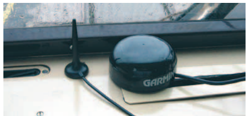
Bild 103: Transportable Funkantenne und GPS-Empfänger (Aufnahme: EEG)
