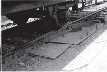
Bild 5: Hemmschuhauswurfbremse
