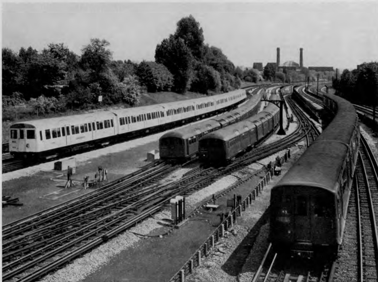
Bild 10. Blick nach Süden von Wembley Park gegen das Kraftwerk Neasdon im Hintergrund, das die Londoner U-Bahn zum Teil mit Strom versorgt. Links ein Aluminiumzug Reihe "A" in Richtung London ausfahrend, rechts ein 8-Wagen-P-Zug für oberirdische Strecken, Baujahr 1938, auf der Ausfahrt Richtung Norden. Die beiden Züge in der Mitte sind 7-Wagen-Kompositionen Baujahr 1938 der Bakerloo-Line
