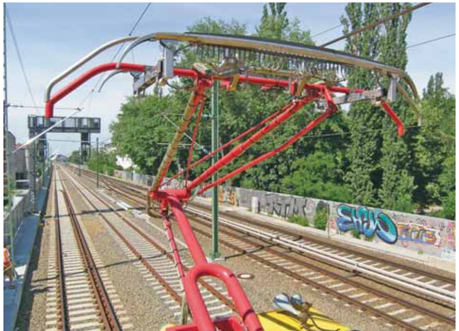
Bild 6: Fahrdrabttagemessung auf dem Nördlichen Berliner Innenring
