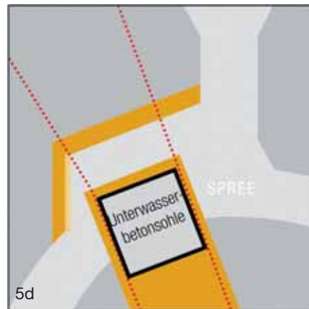
Bilder 5a-5e: Fünf Phasen des Tunnelbaus unter der Spree
