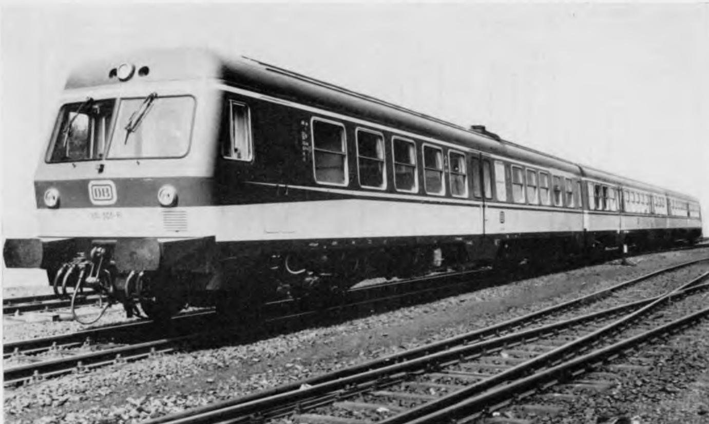
Bild 10: Dieseltriebzug Baureihe 614
