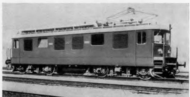
Bild 11. Ae4/4-Lokomotive der BLS, 4000 PS, 125 km/h maximale Geschwindigkeit, 80 t, größte Anfahrzugkraft 22 t, Stundenzugkraft 14,2 t, zwei vierachsige Drehgestelle. Diese Lokomotive vermag einen Wagenzug von 400 t auf den 27 % steigenden Rampen der Lötschbergbahn mit 75 km/h zu befördern. Die Ae4/4-Lokomotive ist bei den SBB zum Ersatz von älteren elektrischen Lokomotiven mit vier Triebachsen vorgesehen
