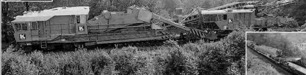
Aus dem Gleisbaumaschinenpark der Firma Hermann Koehne zeigt sich hier die RM 80-92 V mit Nivellieranhängern und MFS-Wagen.
