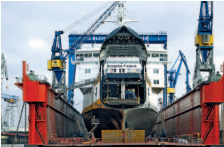
Bild C 3.1-1: Reparatur eines Fährschiffes im Schwimmdock
