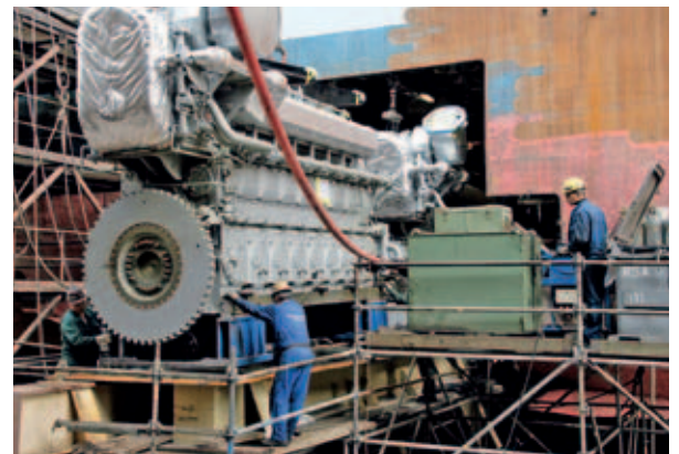
Bild C 3.1-2: Austausch eines Motors
