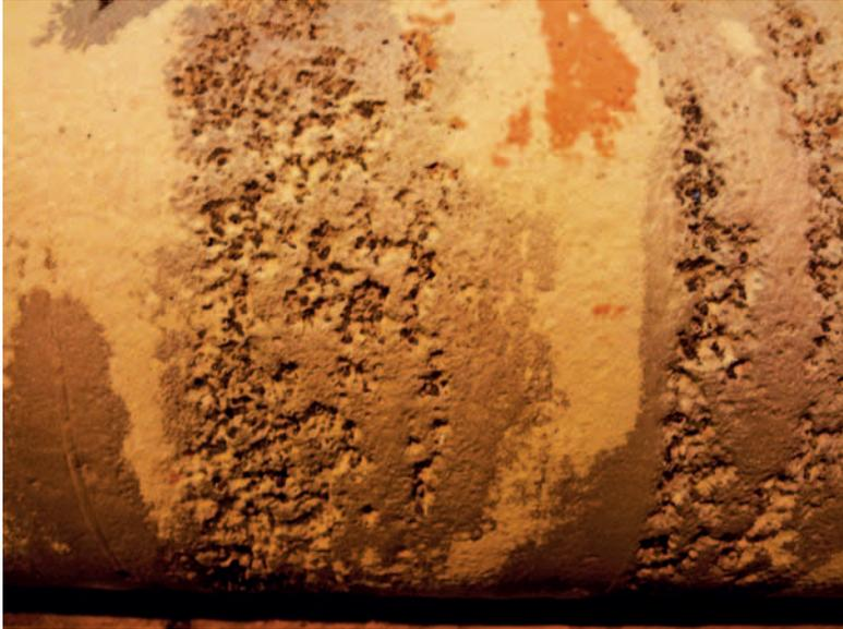
Abb. 1.5: Lochkorrosion, gut sichtbar nach Strahlen der betroffenen Oberfläche
