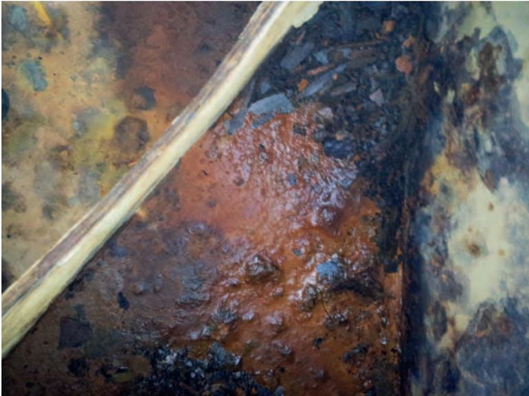
**Abb. 1.9: Mikrobiell induzierte Korrosion im Ballastwassertank**
