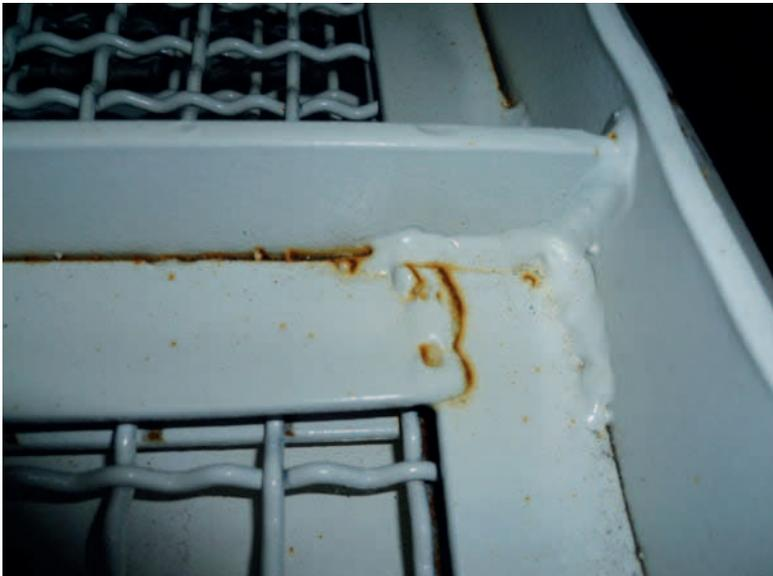
Abb. 1.6: Spaltkorrosion
