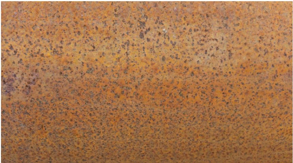
Abb. 1.3: Gleichmäßige Flächenkorrosion
