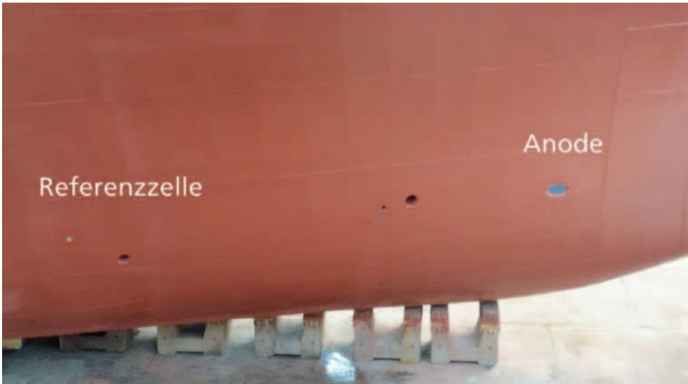
**Abb. 1.10: Fremdstromanlage**
